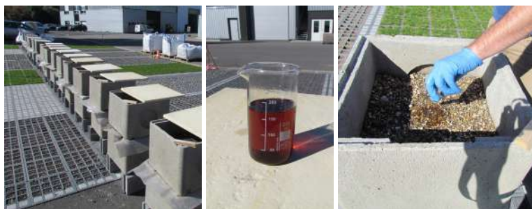
Figure 6 : Vues des colonnes et du dépôt de la pollution sur le substrat
