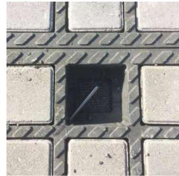
FIGURE 8 : VUE DE LA SONDE À -3 CM DANS UNE ALVÉOLE
