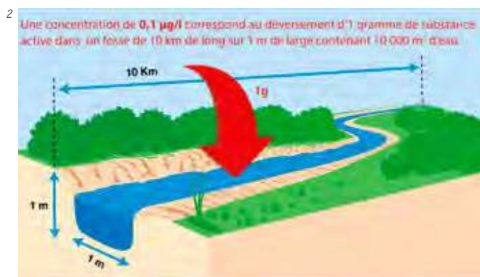
2 - Schéma illustrant le seuil de contamination par les pesticides de l'eau de boisson. Il correspond à une concentration de 0,1 µg/l, soit 0,1 millionième de gramme par litre. © DRAAF - Fredon Centre
