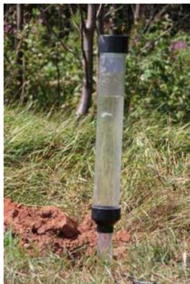
Figuur 2-18: Pask In situ Permeameter
