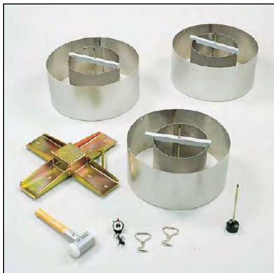
Figuur 2-40: 3 Meetsets voor de dubbele ring methode (bron: https://www.eijkelkamp.com )
