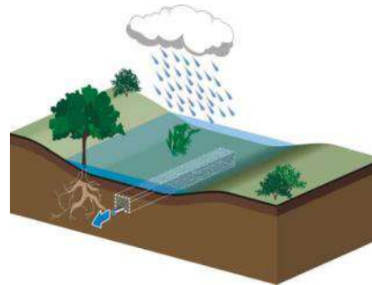
Tijdelijke opslag en evacuatie naar een afvoer
